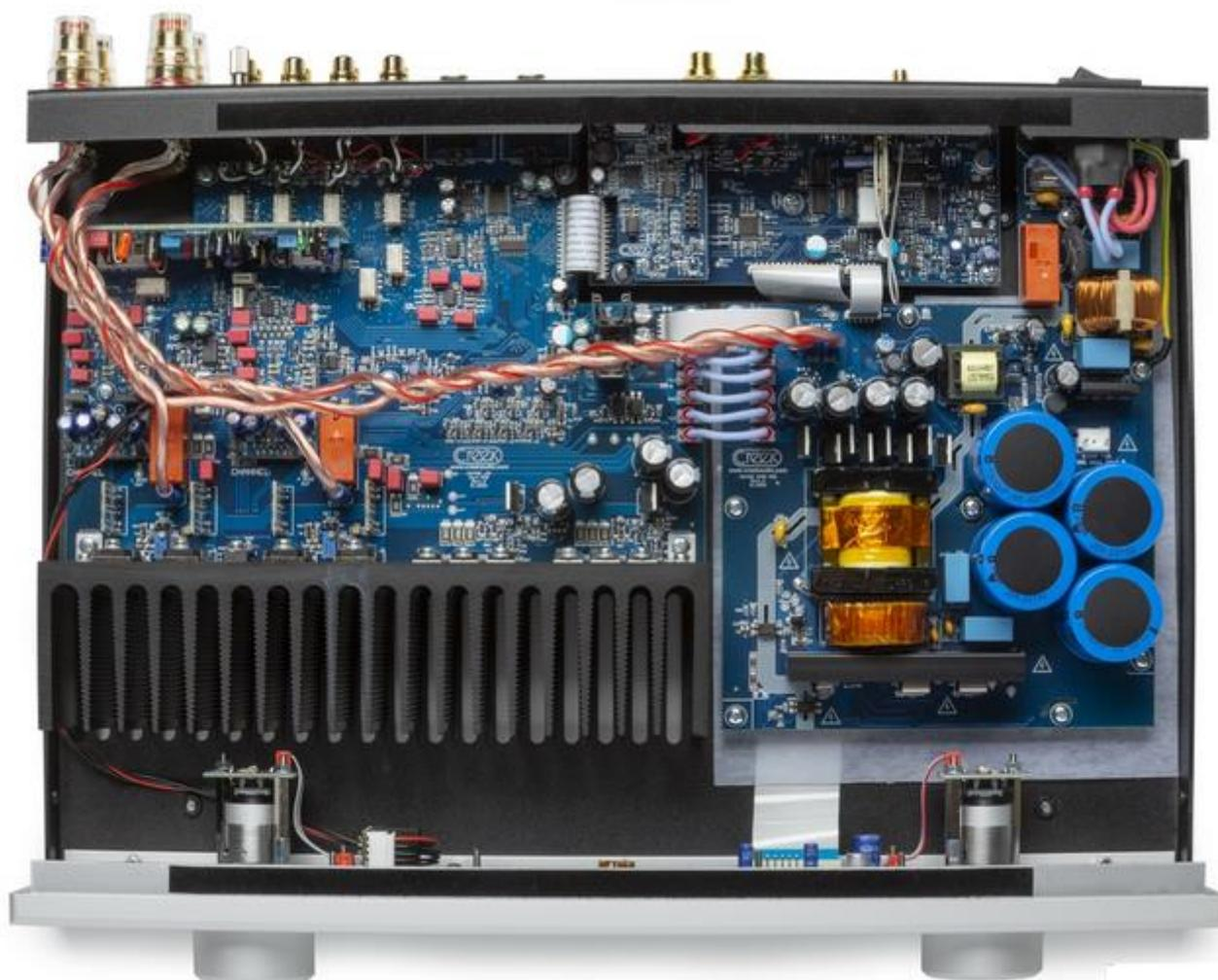
L'étage de puissance s'appuie sur six transistors Mosfet Sanken STD03 à courant élevé. Pour garantir la puissance de sortie annoncée, CREEK a fait le choix d'une alimentation à découpage. Ainsi, le concepteur s'affranchit du ou des classique (s) transformateurs torique (s) et condensateurs de filtrage.
