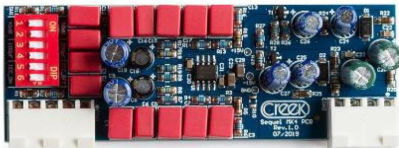
D'origine, le i20 ne possède pas d'étage phono intégré. Une carte phono enfichable optionnelle Sequel-mk4 peut être ajoutée à la demande. Ce module est prévu pour les cellules MM et MC à haut rendement. Il permet la sélection du gain à 40 ou 50 dB, de la capacité de 100 pF ou 200 pF et d'un filtrage CEI, afin de réduire les fréquences de distorsion du disque. Il bénéficie de l'alimentation stabilisée spécifique.
