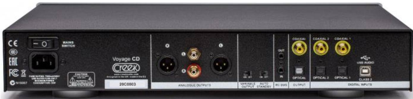
Le verso de cette source est scindé en deux sections : les sorties analogiques au double standard RCA et XLR d'origine Neutrik, et les entrées et sorties numériques, soit 2 entrées numériques S/PDIF coaxiales, 2 entrées numériques Toslink optiques, 1 entrée USB-2 asynchrone 32 bits / 384 kHz. Vous y trouverez aussi 1 sortie numérique S/PDIF coaxiale, 1 sortie numérique Toslink optique.
